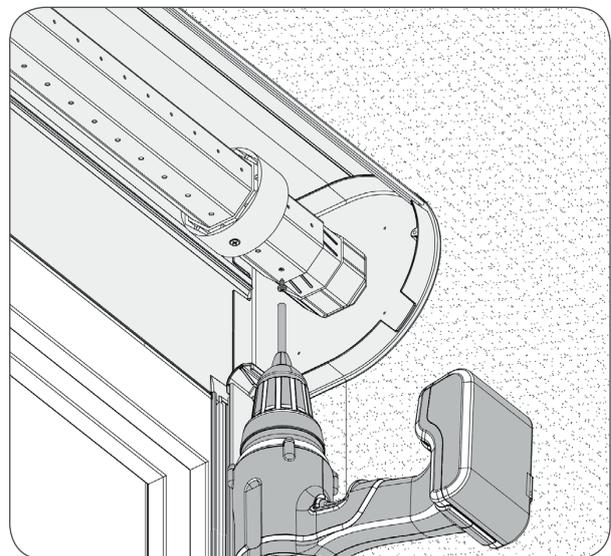
h) Den Panzer aufrollen, den Endstab in die Führungsschienen einlegen und die Endpositionen einstellen.
