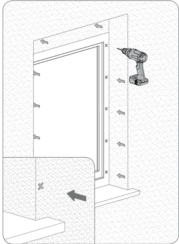
d) Den Kasten und die Führungsschiene anschrauben.
