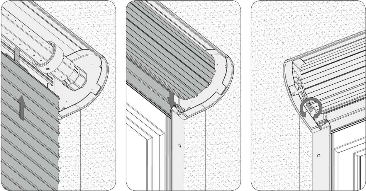
i) Funktionalität überprüfen. Den Kasten Schließen und die Stöpsel einstecken.
