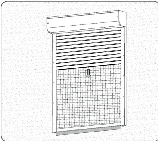
**5. DIE FADEN DIE ZUR ABSICHERUNG DER BÜRSTENDICHTUNG IST NACH DER MONTAGE ZU ENTFERNEN.**
