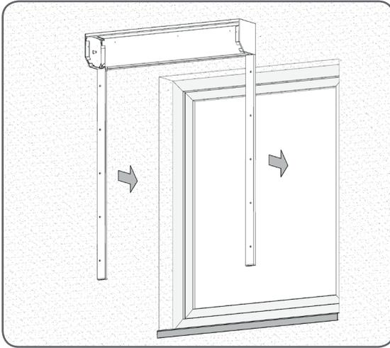
⚠ Abhängig von der Antriebsart, vor der Montage des Rollladen die Stelle der ausführung des Gurtes(Seils), Kurbel oder Motorkabels bestimmen.
