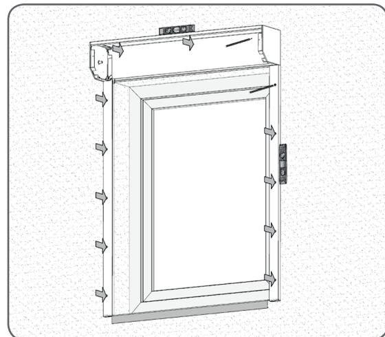
⚠ Abhängig von der Antriebsart, vor der Montage des Rollladen die Stelle der Ausführung des Gurtes(Seils), Kurbel oder Motorkabels bestimmen.
