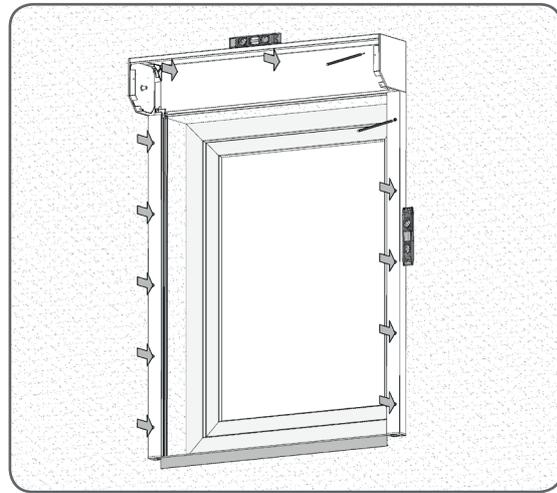
⚠ Abhängig von der Antriebsart, vor der Montage des Rollladen die Stelle der ausführung des Gurtes(Sails), Kurbel oder Motorkabels bestimmen.
