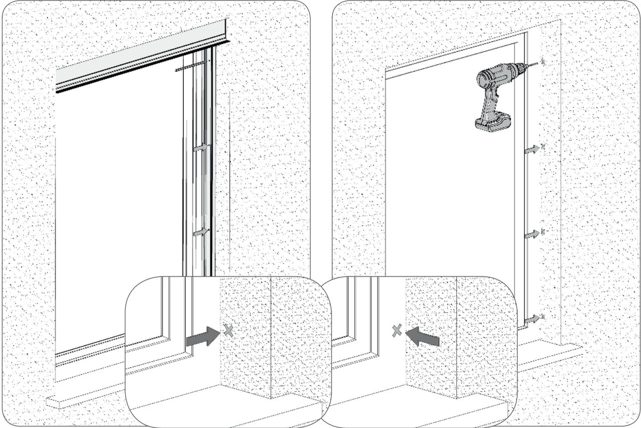
d) Den Kasten und die Führungsschiene anschrauben.
