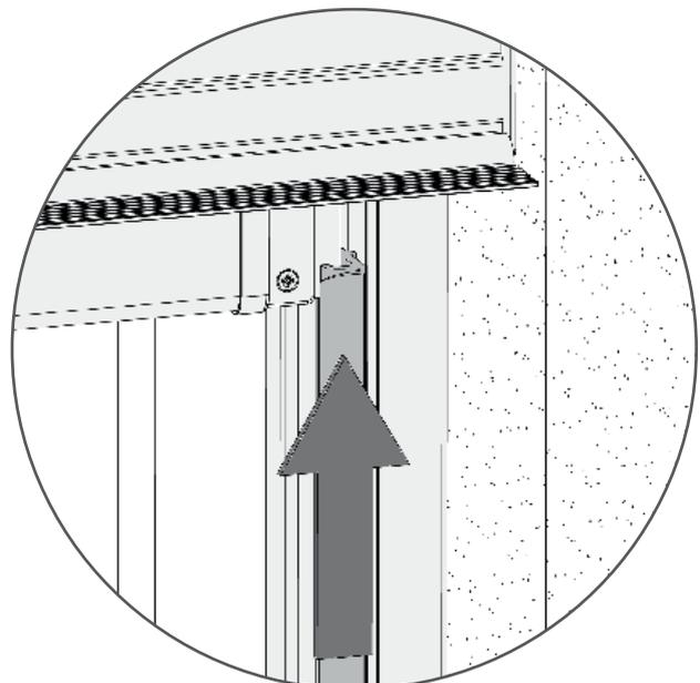
i) Das Vorderteil der Führungsschiene anschrauben.
