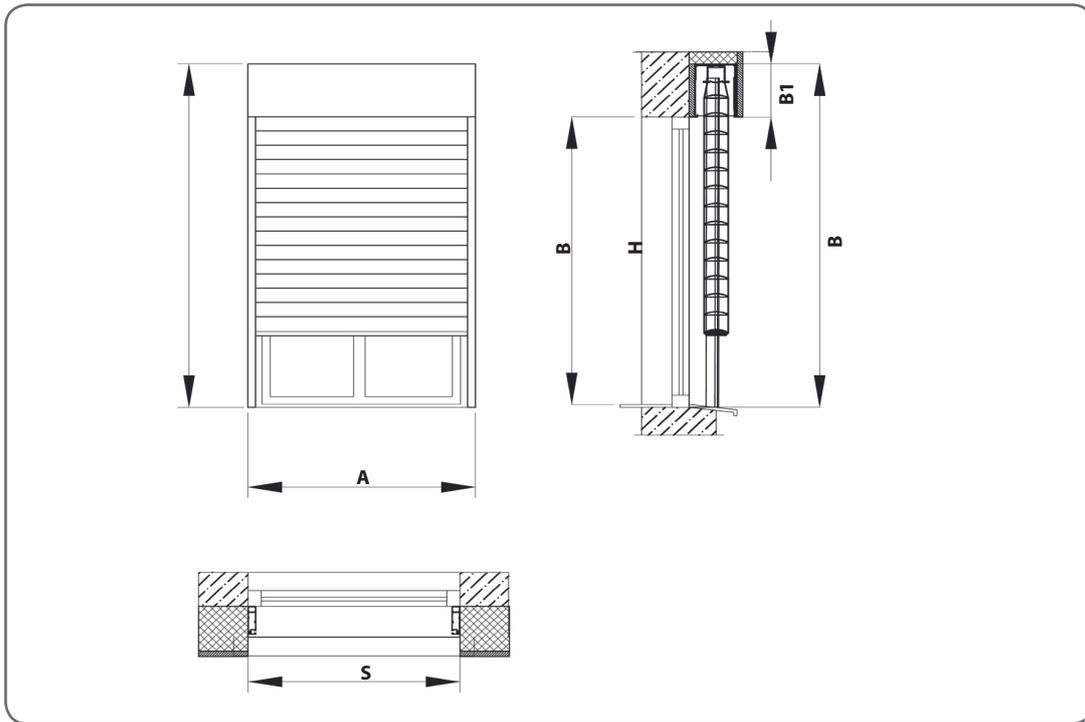
Die Übereinstimmung der Abmessungen der Montagestelle des Raffstoren überprüfen.
