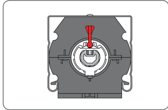
3. Wenn die untere Leiste immer noch nicht senkrecht positioniert ist die regulation durch die Änderung der Position des Bolzens in dem Mechanismus an dem der längste gurt montiert ist.
