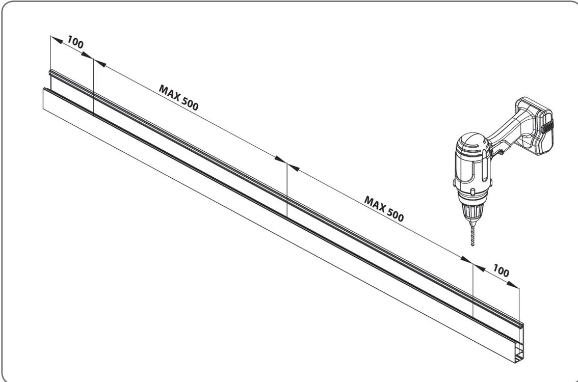
Achtung: Im Falle der Montage der Führungsschienen von der Vorderseite sollen Löcher in der Achse 1, im Falle der Seitenmontage stattdessen in der Achse 2 oder 3, ausgeführt werden.
